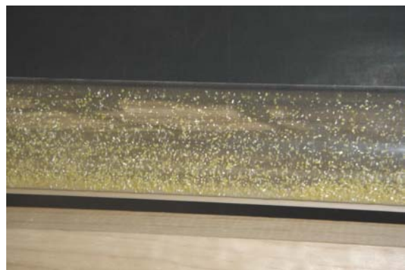
Figura 6: Ensayos con griz de maíz: Transporte horizontal en fase diluída a alta velocidad (flujo homogéneo).
