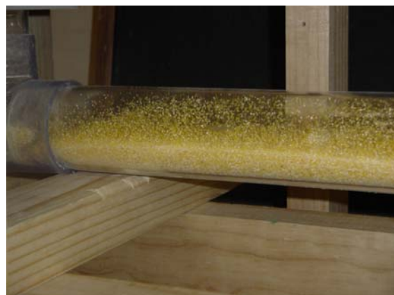
Figura 7: Ensayos con griz de maíz: Transporte horizontal en fase diluída a baja velocidad (depositación de partículas).
